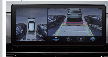
System kamer 360 stopni
