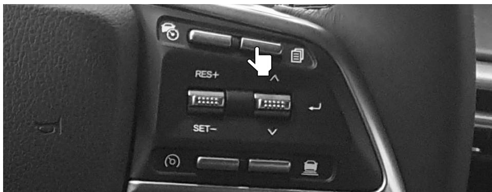
• Stlačením a podržaním prepínača Ponuka na diaľkovom ovládači na volante zdrúženého prístroja (na viac ako 10 sekúnd) reštartujete systém.
