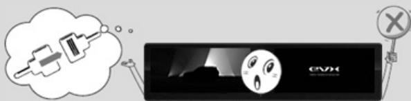
■ از بنزین، تیلن، بنزن، یا محلول های ارگانیک برای تمیز کردن دستگاه استفاده نکنید.
