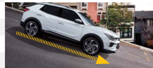
HDC – system kontroli zjazdu ze wzniesienia
